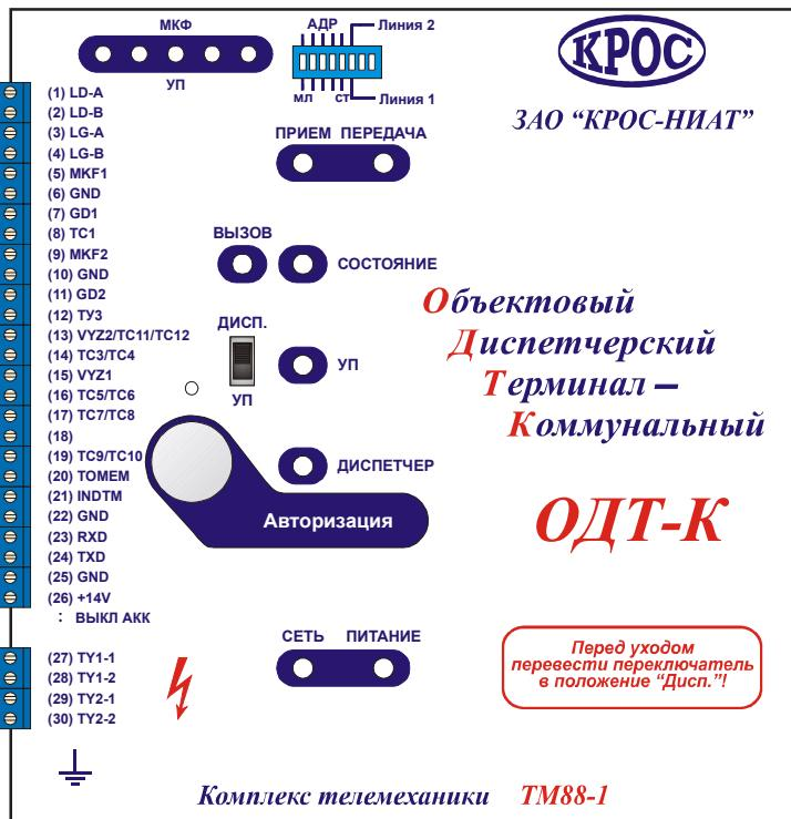
При подключении ОДТ-К к устройствам ПЛР-С всех модификаций установленные на ОДТ-К адреса должны соответствовать адресам в программе конфигурации комплекса. Следует иметь в виду, что следующий за установленным в ОДТ-К адрес используется и устанавливать его в другом устройстве не допускается.
