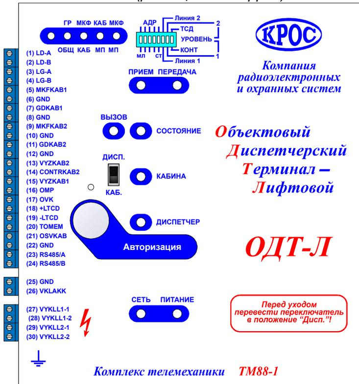
В системах с GSM, Ethernet и радиоканалом установленные на ОДТ-Л адреса: 1,2,3,... соответствуют адресам: 1,2,3.... в программе конфигурации комплекса; в проводной системе с устройством ЦПЛУ установленные на ОДТ-Л адреса: 0,1,2,... соответствуют адресам: 1,2,3,... в программе конфигурации комплекса.
