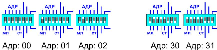
**Установка адреса для проводной системы**
