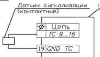
Вариант 2 (контроль обрыва и короткого замыкания щейфа сигнализации)
