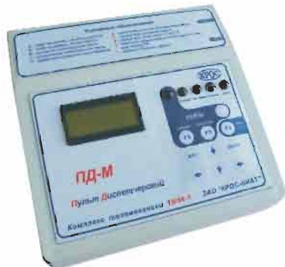
Тип канала связи LD/LG – двух- или четырёхпроводная линия. Удаление по кабелю ОДТ-Л или УДКЛ – не более 2,5 км. Тип используемого кабеля – ТППЭп, UTP, FTP (при двух- или четырёхпроводной линии) или П-274 (при двухпроводной линии).
