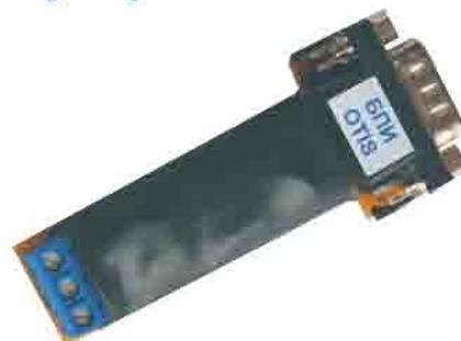
**Блок преобразователя интерфейса БПИ УЛ-RS485 –
