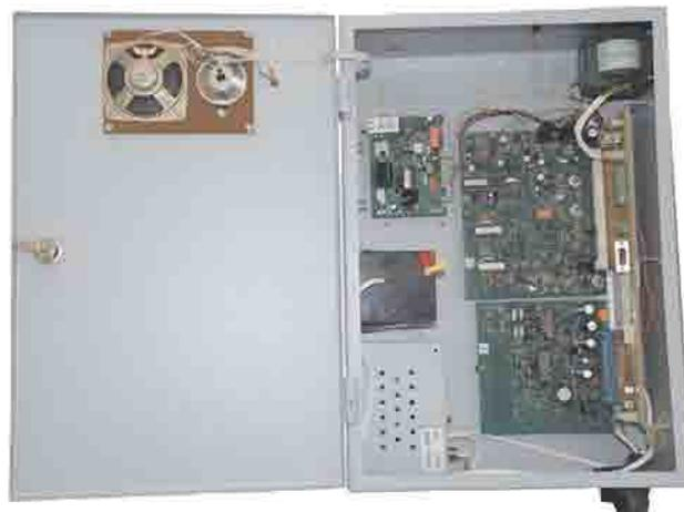
**Устройство бесперебойного питания и видеоконтроля УБПВК**
