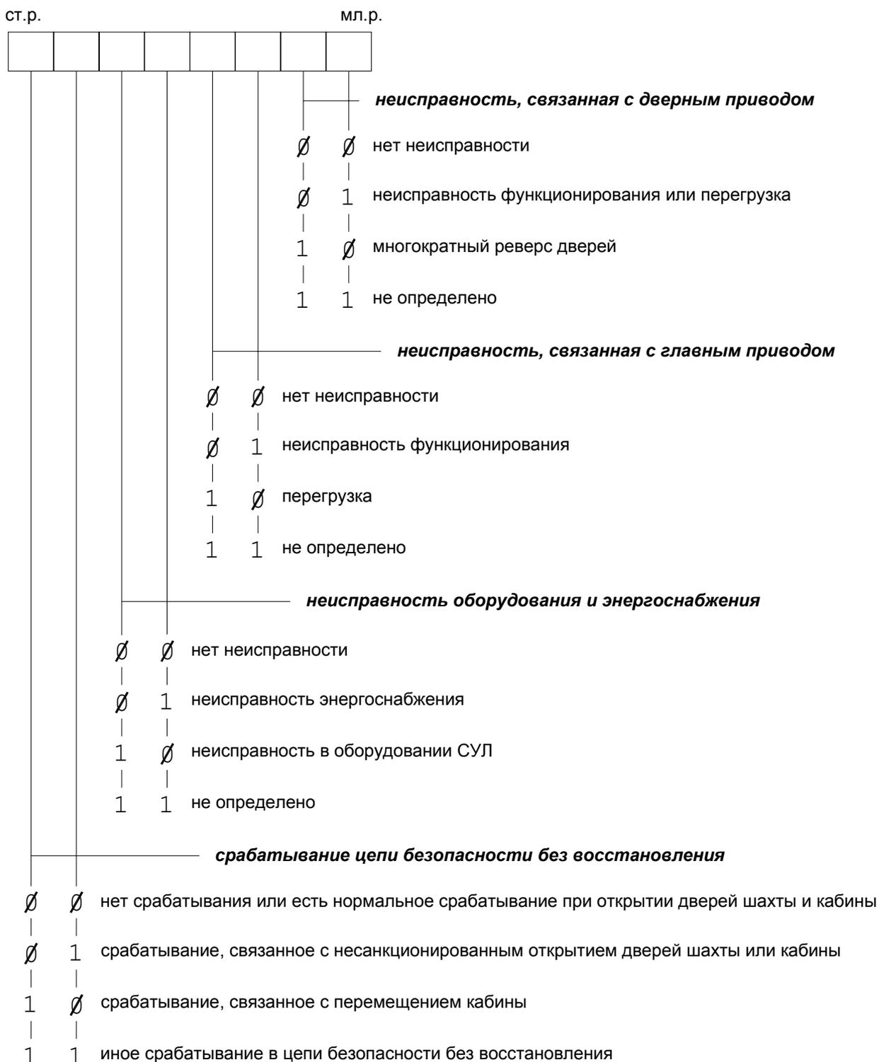
Рисунок Г.6 Унифицированный идентификатор неисправности СУЛ
